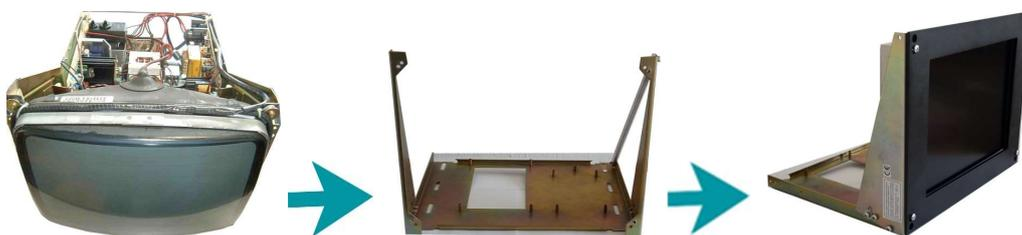
9. Befestigen Sie den TFT-Monitor mit den mitgelieferten Abstandsbolzen so in dem Röhrengehäuse, dass der Monitor so nah wie möglich an der Scheibe des Bedienpanels sitzt.
